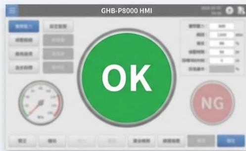
[ 實際壓力  $\geq$  設定壓力 ] + [ 保壓時間  $\geq$  設定時間 ] = **OK**
